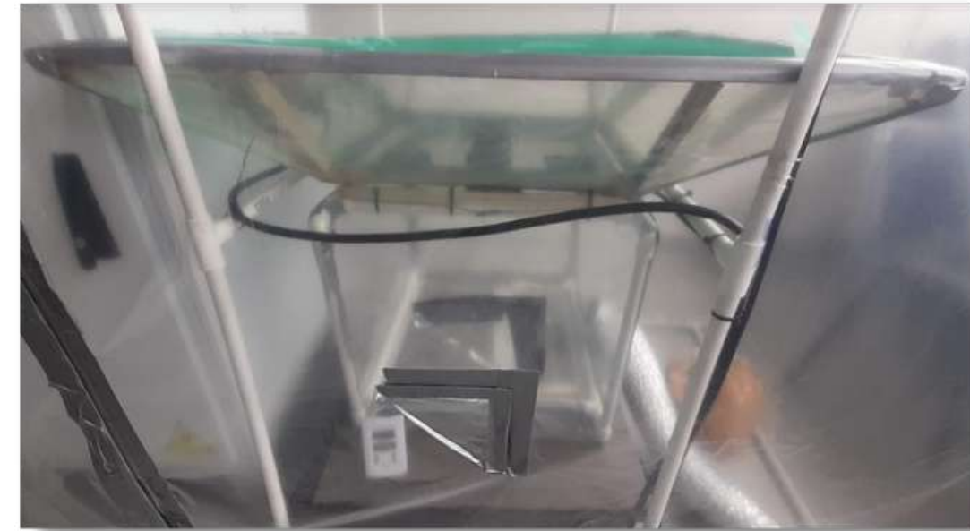
Cámara generadora de PM
