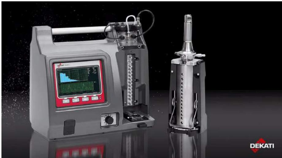
Instrumento usado para medir # partículas /cm<sup>3</sup>: ELPI®+. Dekati®
