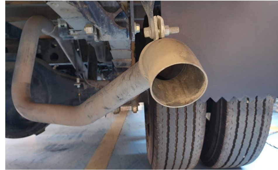
Tubo de escape de vehículo con filtro de partículas
