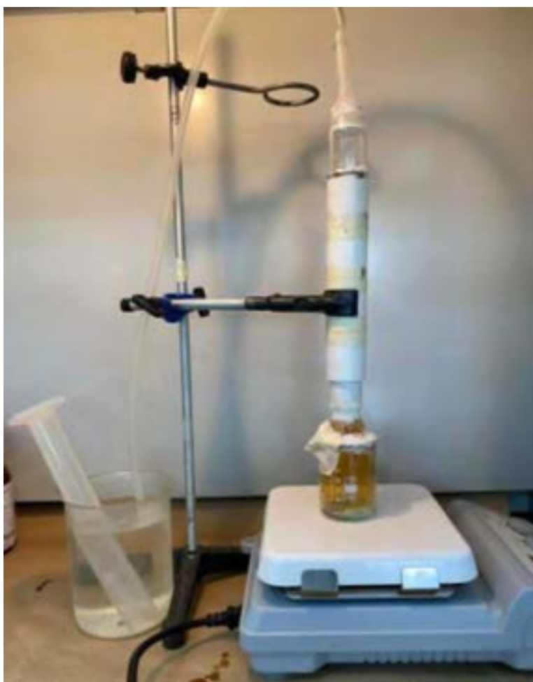
Figura 4. Montaje experimental columna con eco material. Fuente: Autoría propia, 2025.
